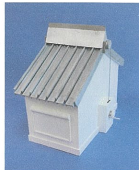
図4. 落雪時 屋根沈下
